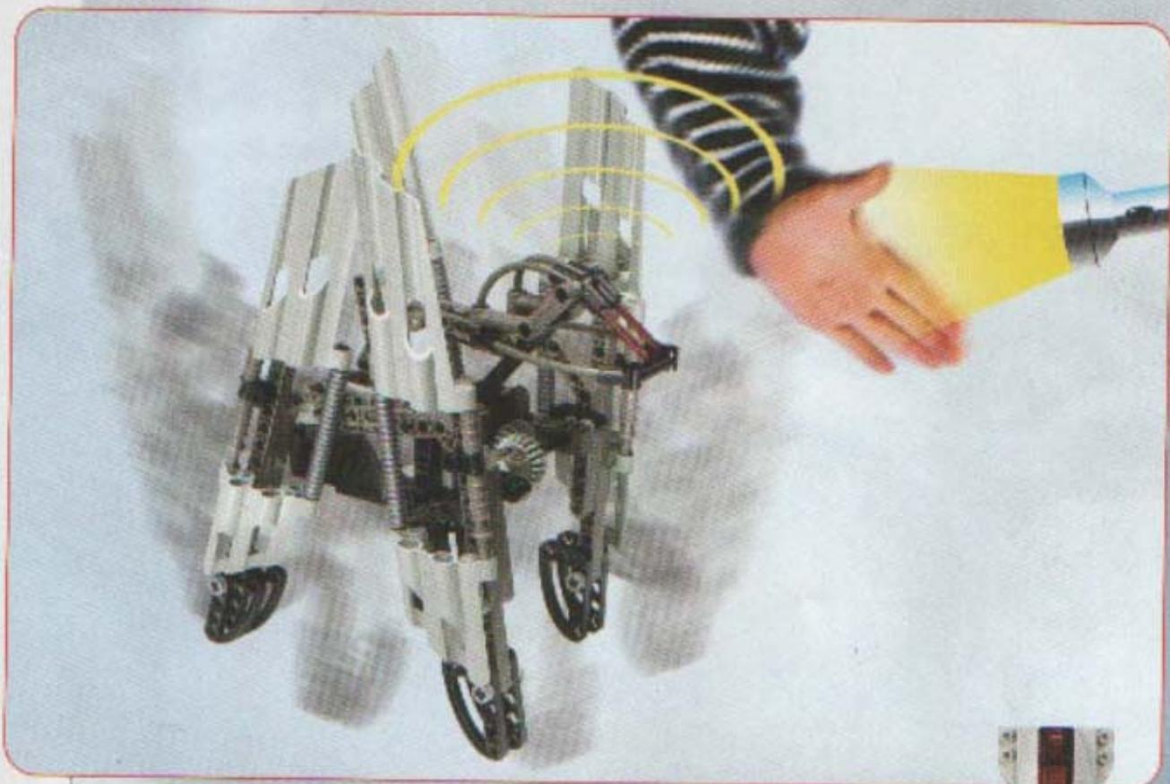
Mit Select (Auswahl) und Run (Start) führst du Programm 6 (Alarm) aus. Ändert sich das Licht, so fährt der Droiden-Raumjäger los und lässt ein Alarmsignal ertönen.
