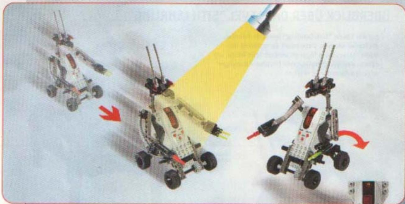
Mit Select (Auswahl) und Run (Start) führst du Programm 3 (Dem Licht ausweichen) aus. L-8GO fährt vorwärts. Sobald er ein Licht sieht, fährt er zurück und dreht um.
